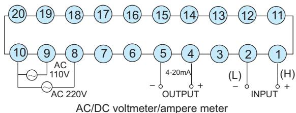
AC/DC voltmeter/ampere meter
